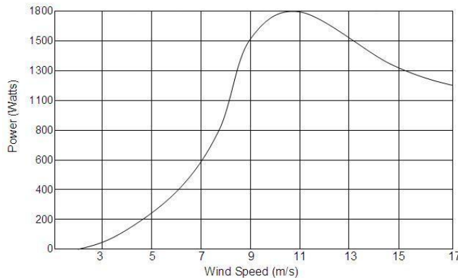
Figura 2-12 Gráfica de potencia nominal del aerogenerador seleccionado.
