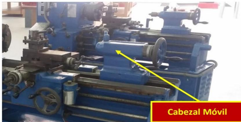
**Figura 5-** Cabezal móvil de un torno
