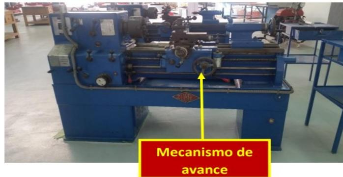
**Figura 8-** Torno convencional y mecanismo de avance.
