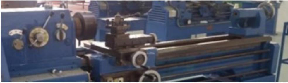
**Figura 3-** Bancada de un torno.
