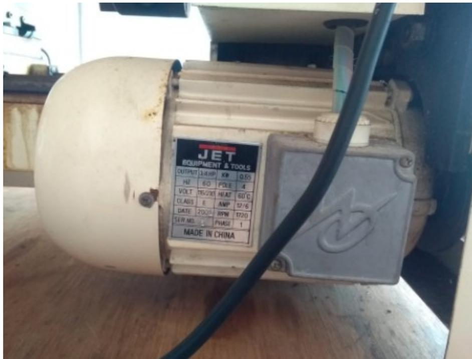
**Figura 17** - Motor principal del torno.
