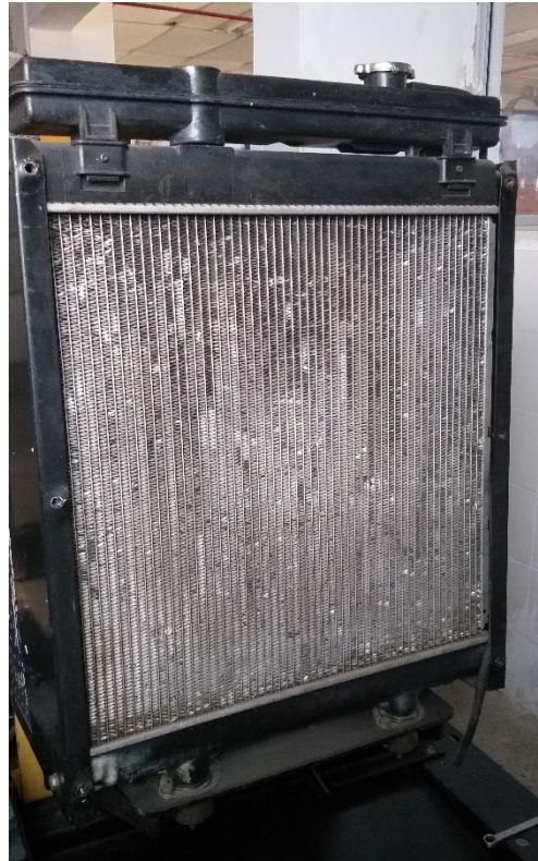
Figura 7.2 Detalle del intercambiador de calor.
