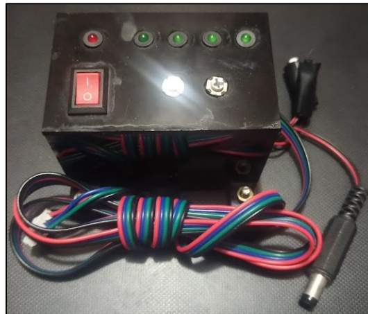
Figura 10. Circuito de control de velocidad de la bomba jeringa
