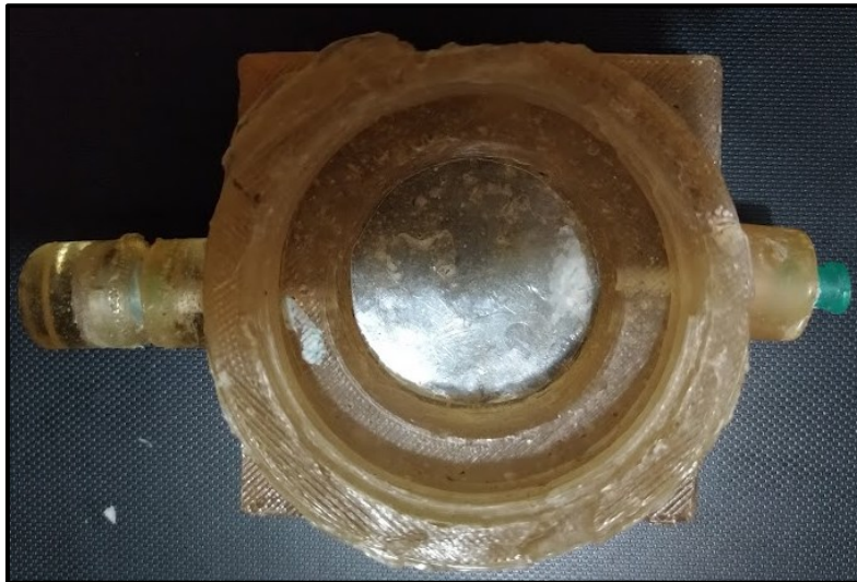
Figura 20. Resultado de pieza en resina servida en molde de caucho
