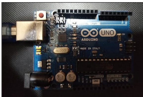
Figura 6. Placa de Arduino UNO, estación de mando y control de los circuitos electrónicos
