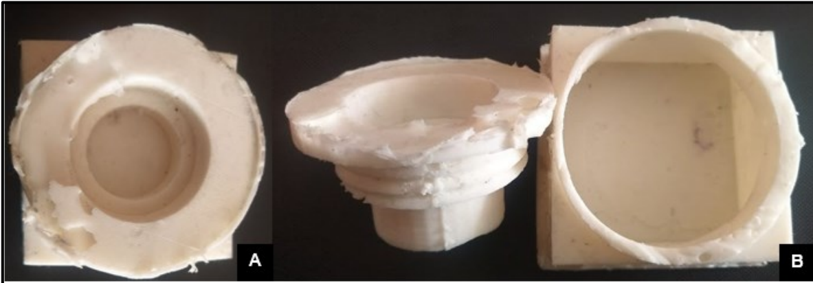
Figura 19. Moldes en caucho de caja de filtración tangencial. (A) Vista superior de caja completa de filtración tangencial. (B) Acople de roscado para rendija de la caja de filtración junto al cajón de procesamiento de muestra
