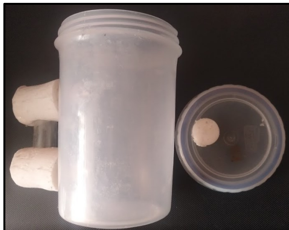
Figura 17. Recipiente de polipropileno con codo en caucho siliconado y tubo de vidrio. Junto a tapa con empaque de protección en caucho siliconado empleado como biorreactor.
