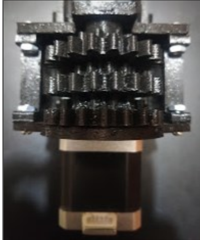
Figura 9. Sistema de piñones de jeringa acoplado a motor paso a paso Nema 17- 52 N
