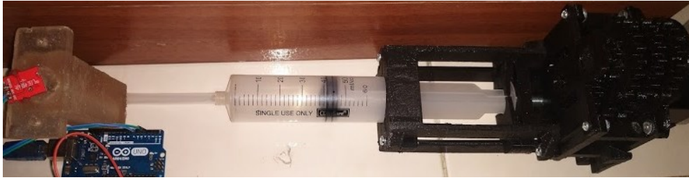
Figura 16. Montaje de calibración de sensor de presión
