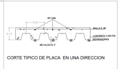
CORTE TÍPICO DE PLACA EN UNA DIRECCION
