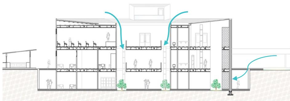
*Ilustración 71: Corte sistema ventilación natural.*
