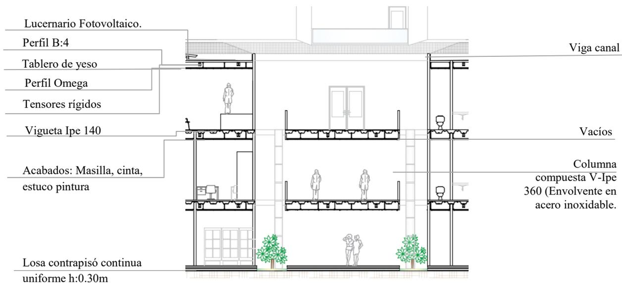
*Ilustración 61: Detalle interno de elementos y materiales. Fuente: Elaboracion propia.*
