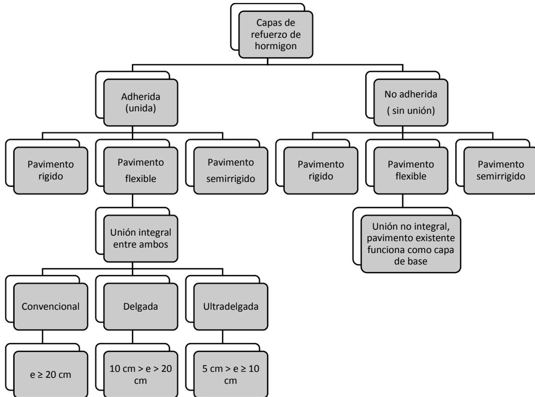
Nota: El diagrama muestra el tipo de capas de refuerzo de hormigón (Whitotopping) y sus usos dependiendo el tipo de pavimento. Fuente: Tomado y modificado de (Morales, 2004)
