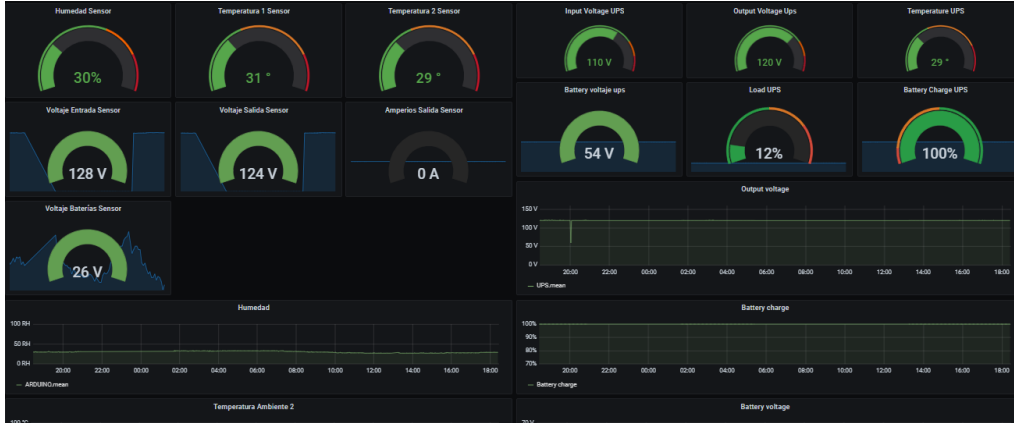
Figura 5-19.: Interfaz integrada monitoreando datos del UPS y datos del Arduino Nano
