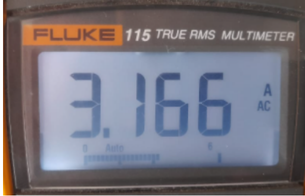
Figura 4-17.: Corriente medida por el multmetro en la escala de 10 Amperios
