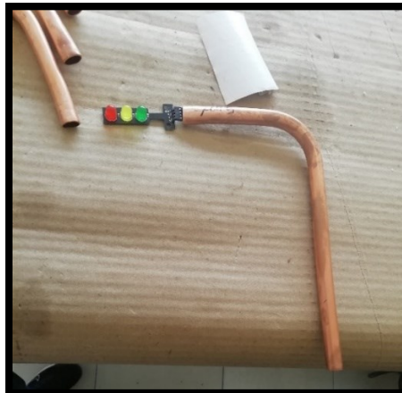
Ilustración 26: corte y doblado de tubos de cobre de ½ pulgada ( funcionaran como los postes de los semáforos )
