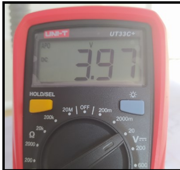
Ilustración 111: Resultados arrojados en la medición (el voltaje puese estar entre 3.8 y 5 VOLTIOS)
