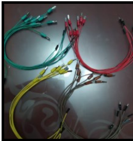
Ilustración 38: cables DuPont de 30 cm con pines tipo pala en uno de los extremos
