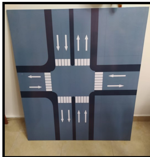
Ilustración 24: Lamina de acrílico de 100 cm de largo x 90 cm de ancho x 1 cm de espesor ( funcionara como base para la mesa del banco y soporte para la maqueta )
