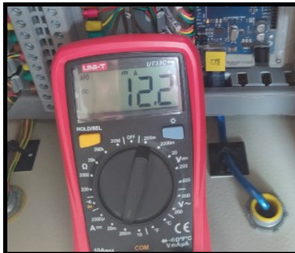
Ilustración 114: Resultados de la medición del parámetro de corriente (cada módulo consumen 6.1 mA como son 2 módulos por semáforos eso da un consumo de 12,2 mA).
