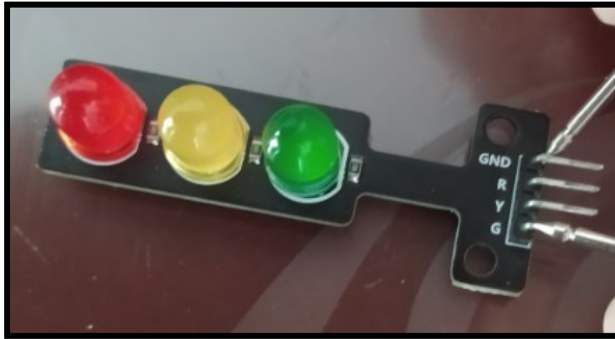
Ilustración 108: Revisión de estado de los leds de los módulos con el parámetro de continuidad (led verde).
