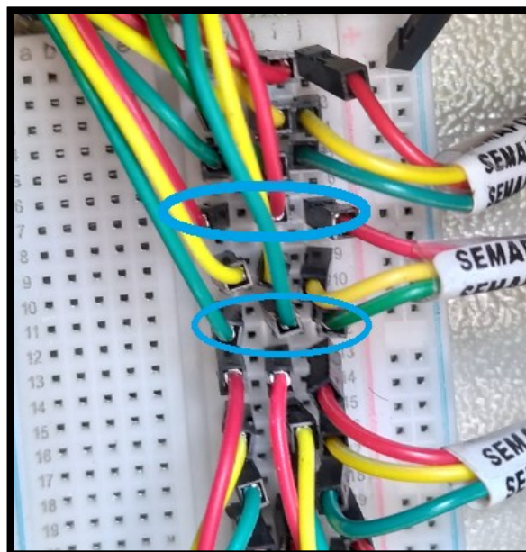
Ilustración 96: Revisión del correcto posicionamiento de los pines en las respectivas líneas para su energización.
