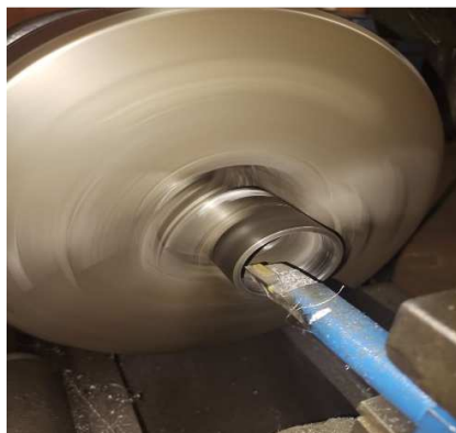
Figura 4.5 Proceso de torneado de bujes
