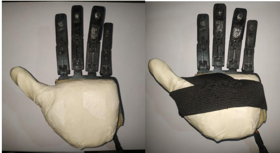
Figura 5-6: Acople de la prótesis con el simulador de pulgar.
