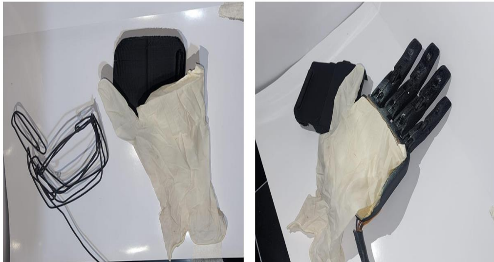
Figura 4-46: Estructura de pulgar artificial para simulación de agarres.
