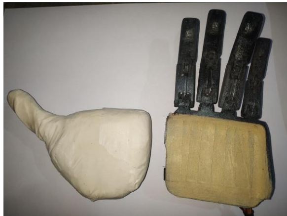
Figura 5 -5: Estructura de prótesis y simulador de pulgar.
