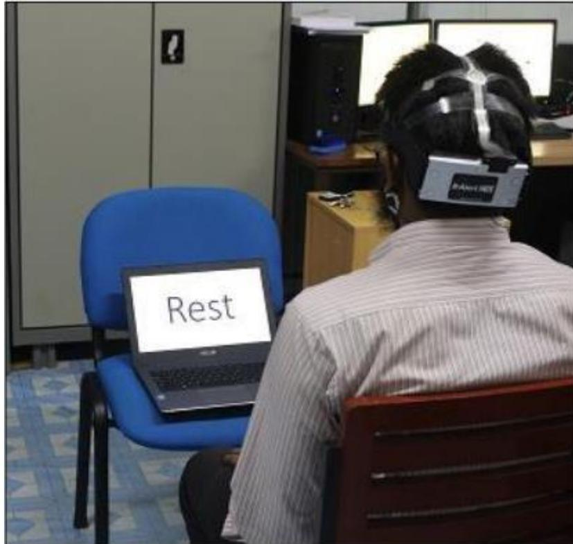
**Figura 2.** Procedimiento de adquisición de datos de EEG de MI utilizando el dispositivo inalámbrico B-Alert X-10 con un mando asistido por ordenador
