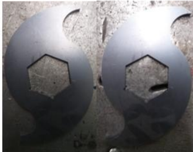
Figura 2-27 Cuchillas de corte
