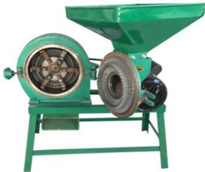
Figura 1-3 Molino de disco
