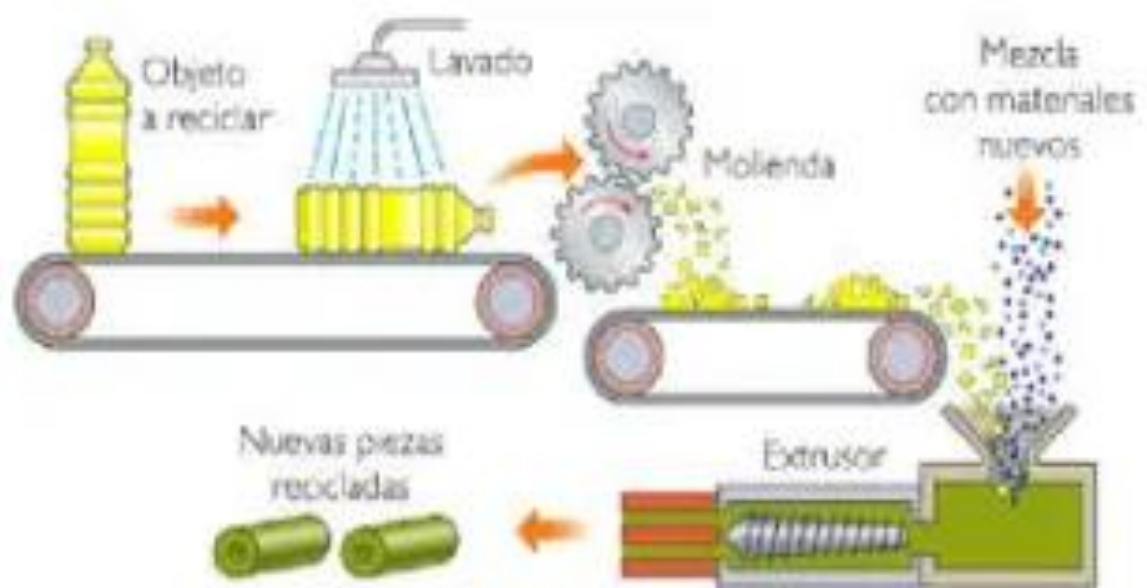
Figura 1-10 Proceso de reciclado mecánico
