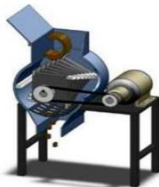
Figura 1-4 Molino triturador de cuchillas
