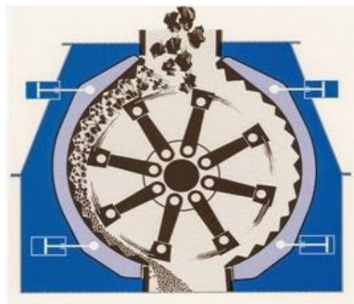
Figura 1-5 Triturador de martillos
