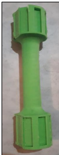
Figura 44. Montaje del eje en carcadas.
