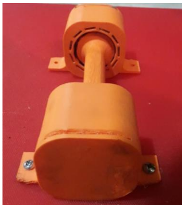
Figura 46. Montaje de carcasas y eje sobre la base.
