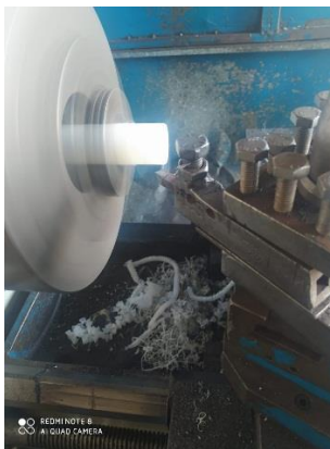
Figura 47. Fabricación de anillos en teflón.
