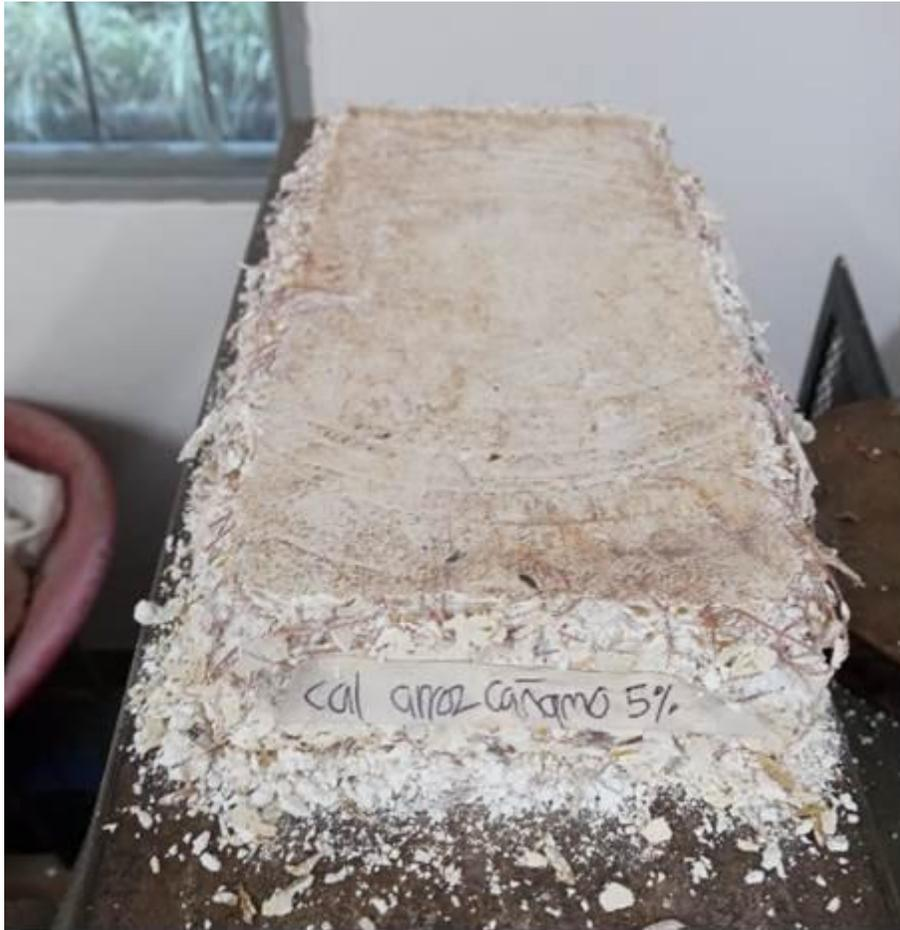
**Figura 39.** Ladrillo cal, arroz al 5% y cáñamo al 5% luego de la prueba a compresión
