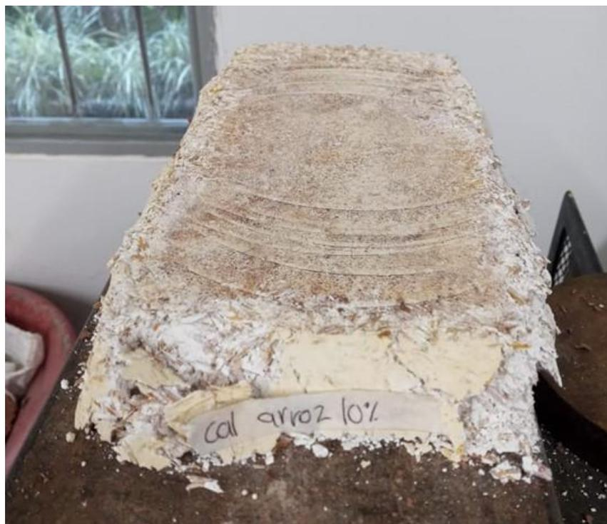
**Figura 41.** Ladrillo cal, arroz al 10% antes de la prueba a compresión
