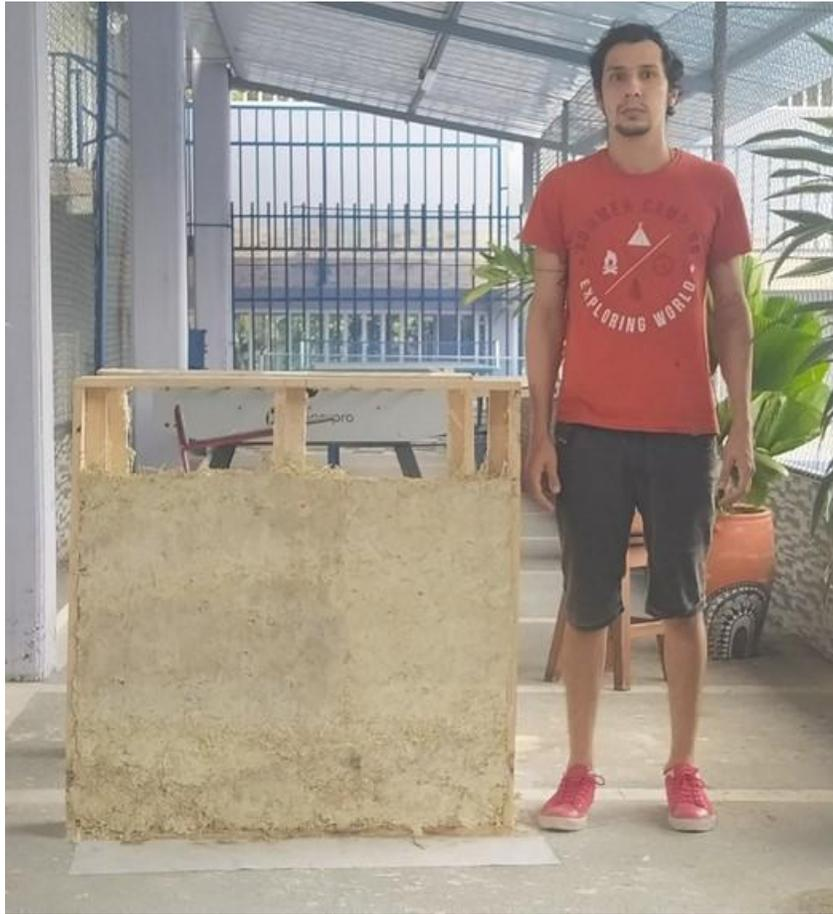
**Figura 31.** Muro 2 de cascarilla de arroz cal hidratada y cáñamo
