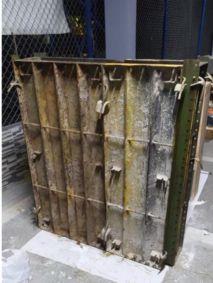
**Figura 26.** Encofrado con formaleta metálica
