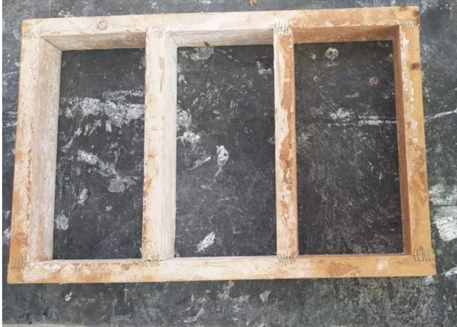
**Figura 21.** Molde de ladrillos en madera
