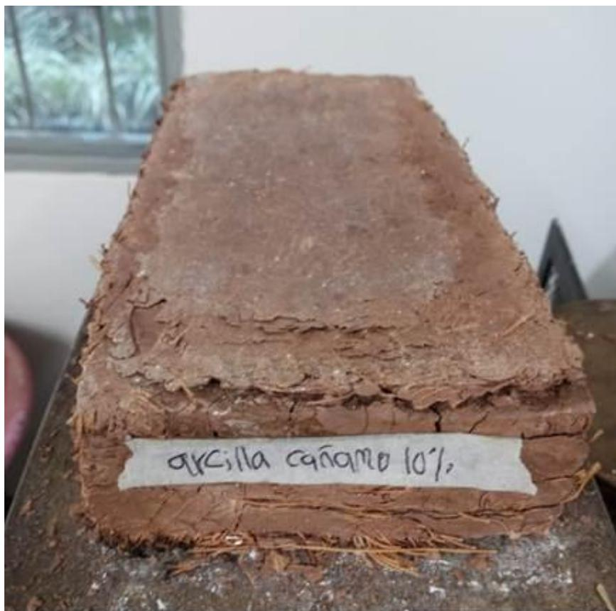
**Figura 43.** Ladrillo arcilla, cáñamo al 10% luego de la prueba a compresión
