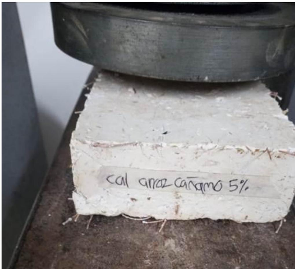
**Figura 38.** Ladrillo cal, arroz al 5% y cáñamo al 5% antes de la prueba a compresión
