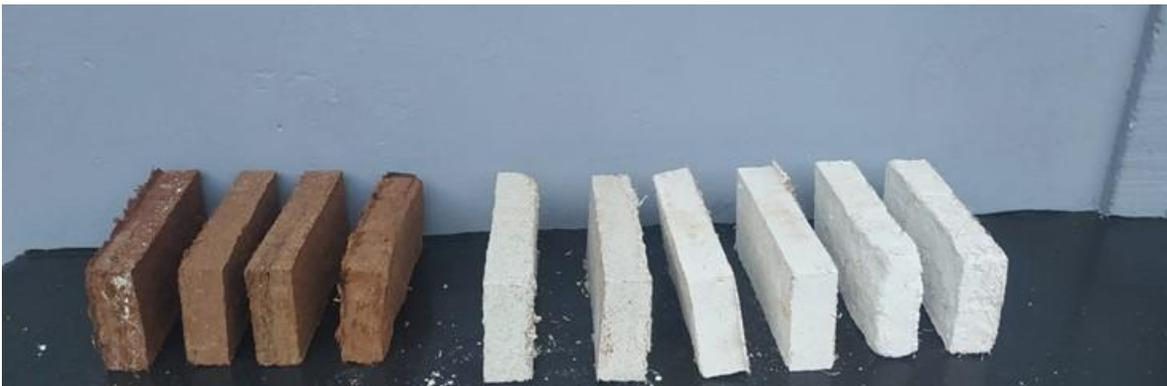
**Figura 24.** Ladrillos para pruebas de compresión
