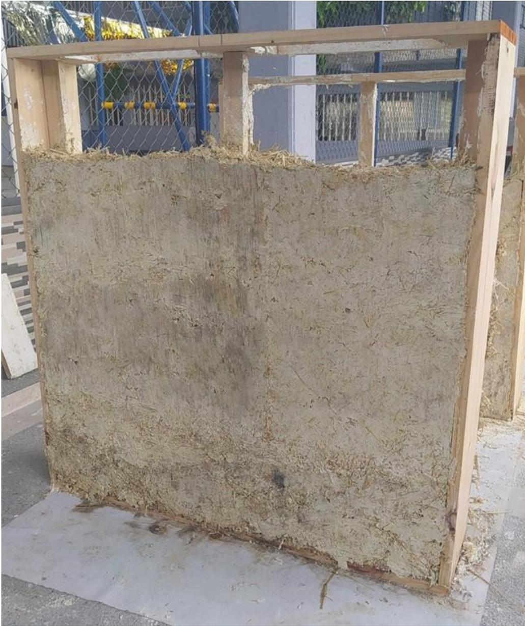
**Figura 29.** Muro 1 cal hidratada y cáñamo
