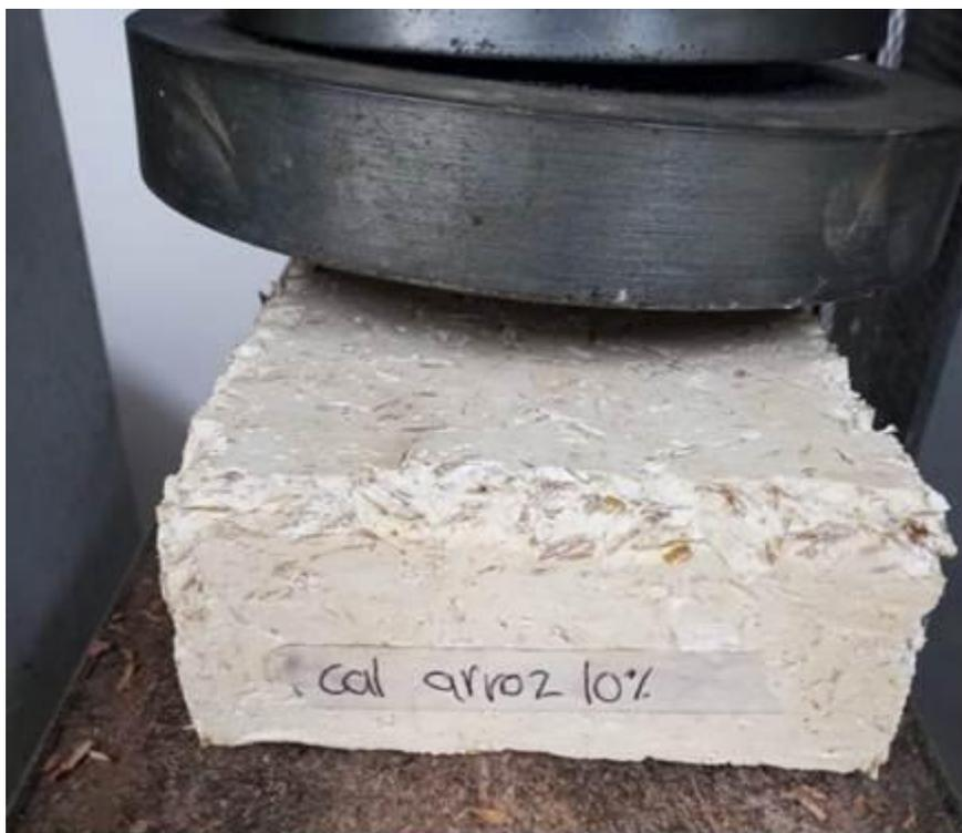
**Figura 40.** Ladrillo cal, arroz al 10% luego de la prueba a compresión
