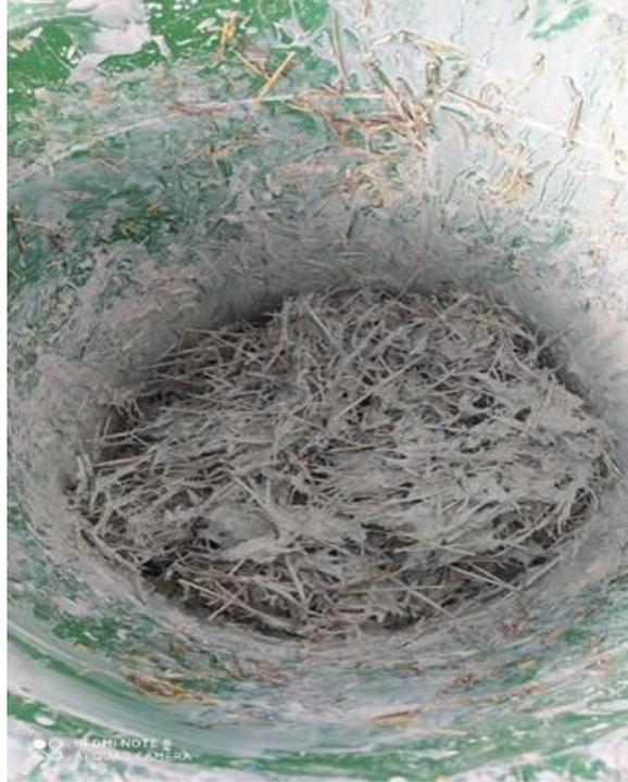
**Figura 27.** Mezcla de cal, cáñamo y cascarilla de arroz
