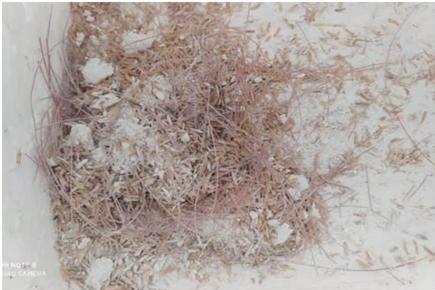
**Figura 22.** Mezcla de cal hidráulica con adición de fibra de cañamo y cascarilla de arroz
