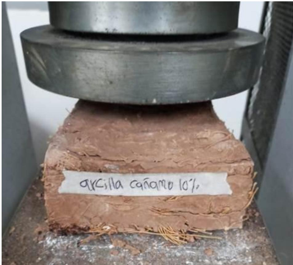
**Figura 42.** Ladrillo arcilla, cáñamo al 10% antes de la prueba a compresión
