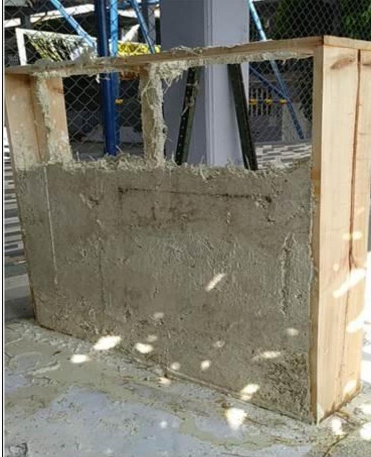
**Figura 30.** Muro 2 de cascarilla de arroz al 5% cal hidratada y cáñamo
