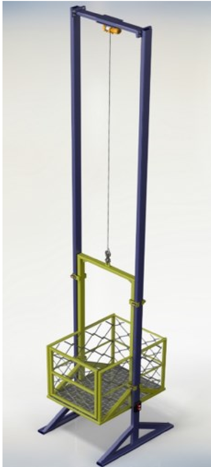
Figura 3-28. Ascensor de Carga Vista Isométrica.
