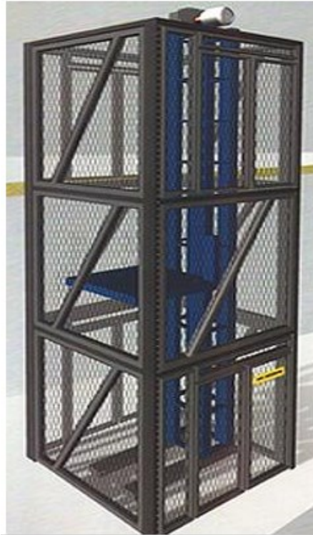
Figura 2-5 Estructura Metálica Ascensor de Carga.
