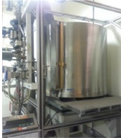
Figura 2-7: Tanque medidor de volumen
