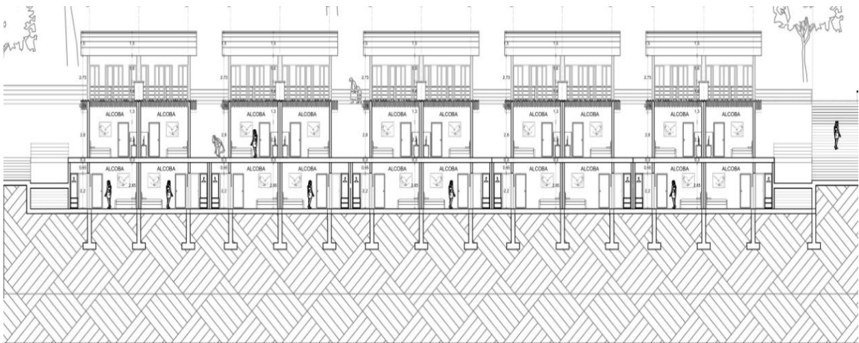
Ilustración 61. Corte de Fachada Cabañas Tipo 2
