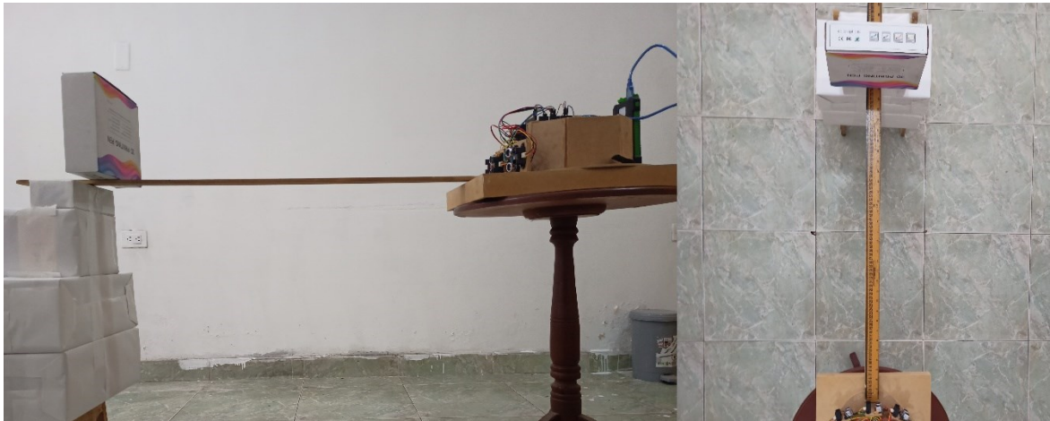
Figura 3-5 Estructura construida para la calibración del sistema.
