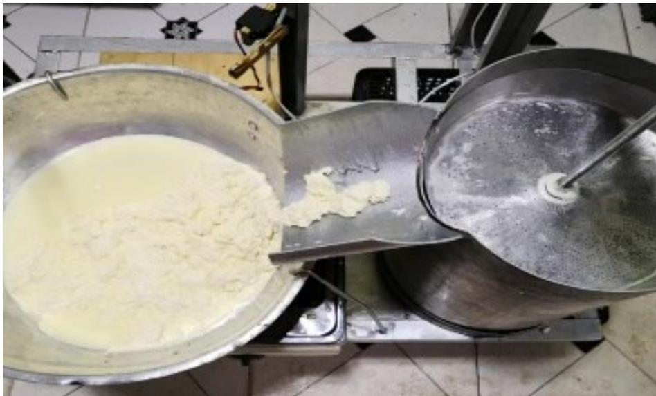
En este punto empieza el primer brazo a realizar el trabajo de revolver el cuajo durante el tiempo programado:
