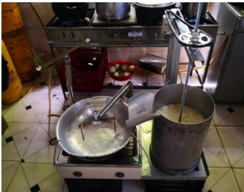
A continuación, se muestra la imagen donde el sensor detecta que la plataforma está en su punto exacto para sonar la alarma donde el operario llega para trasladar el cuajo al siguiente proceso.
