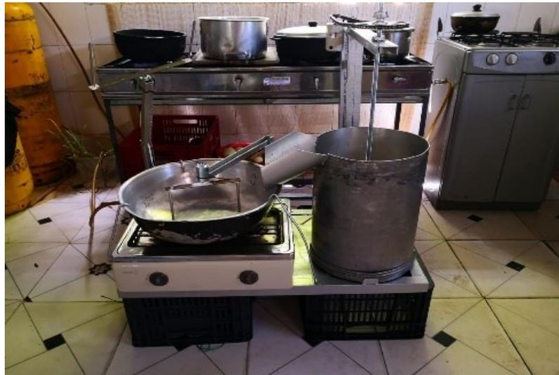
En la figura 3.3, se encuentra el cuajo listo para hacer la separación, donde inicia el proceso el tornillo sin fin hasta llegar a la parte superior de la plataforma.
