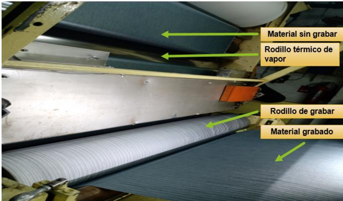
Figura 2-2: Proceso de grabado por rodillos.
