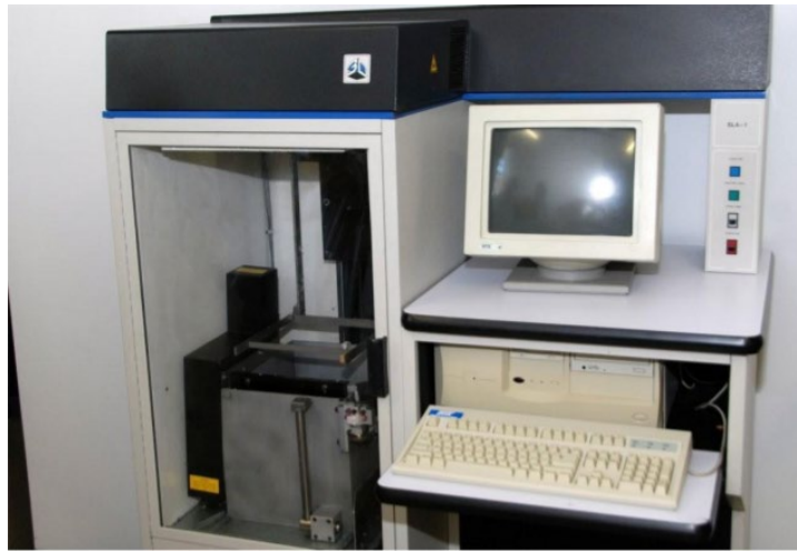
Figura 1-4 Máquina SLA-1 inventada por Charles “Chuck” Hull en 1987 y actualmente
