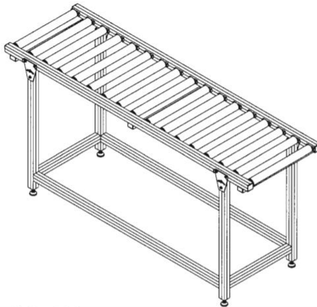
Figura 1-2: Configuración de un transportador de rodillos.
