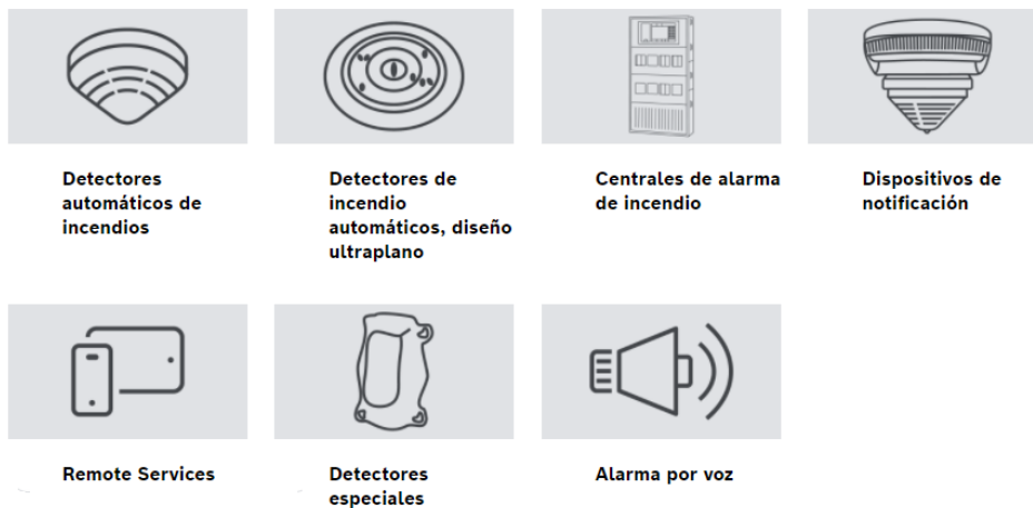
Fig. 1-4: Elementos de un sistema de detección
