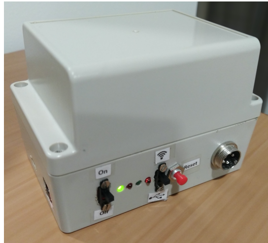
Figura 3.2: Unidad de conexión de los sensores inerciales. Fuente: Elaboración propia
