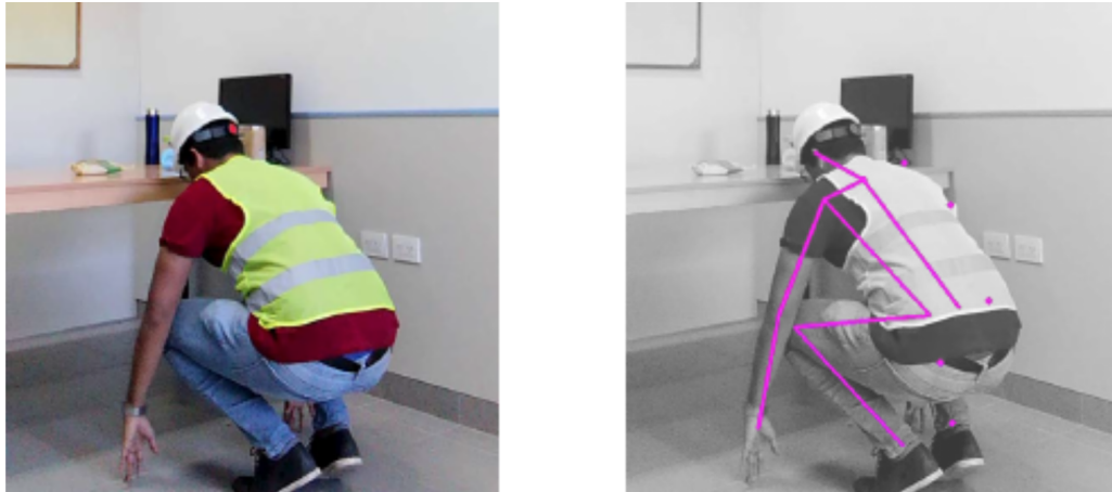
Figura 2.13: Sistema óptico sin marcadores Openpose. Fuente [49].
