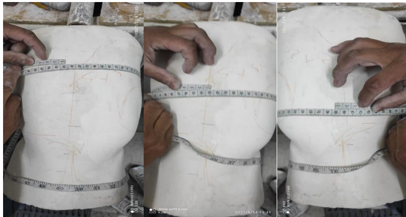
Figura 4-2: Hacen referencia toma de medidas de contornos (1,2,3) respectivamente, utilizando cinta métrica sobre un molde positivo de yeso. Fuente[propia]
