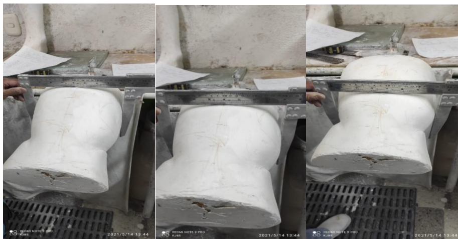
Figura 4-4: Hacen referencia toma de medidas de contornos (1,2,3) respectivamente, utilizando pie de rey sobre un molde positivo de yeso. Fuente [propia]
