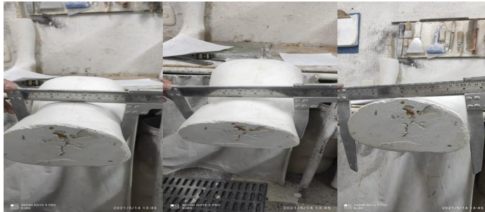
Figura 4-5: Hacen referencia toma de medidas de contornos (4,5,6) respectivamente, utilizando pie de rey sobre un molde positivo de yeso. Fuente [propia]
