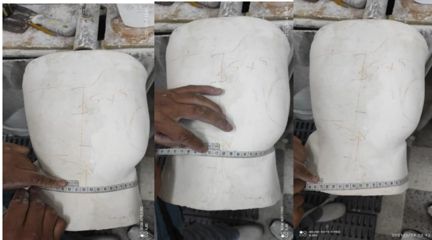
Figura 4-3: Hacen referencia toma de medidas de contornos (4,5,6) respectivamente, utilizando cinta métrica sobre un molde positivo de yeso. Fuente [Propia]
