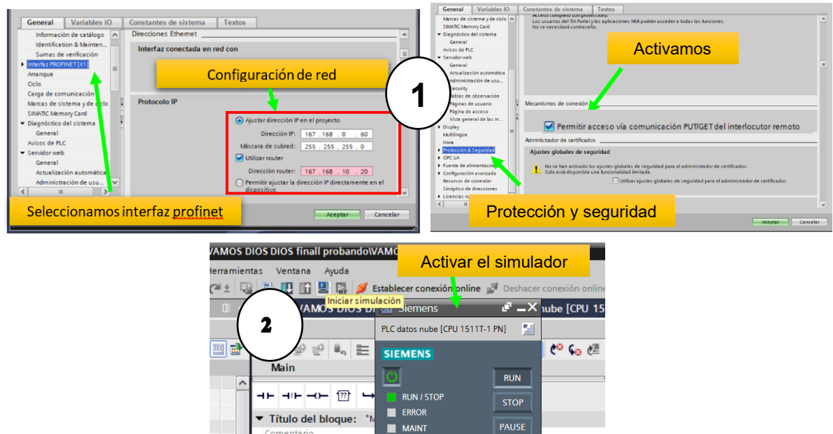
Ilustración 74, configuración de las propiedades del sistema TIA portal, elaboración fuente propia
