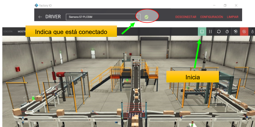
Ilustración 60, correr simulación en el Factory IO, elaboración fuente propia.
