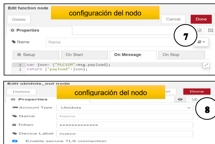
Ilustración 78, configuración nodo function y nodo ubidots, elaboración fuente propia.
