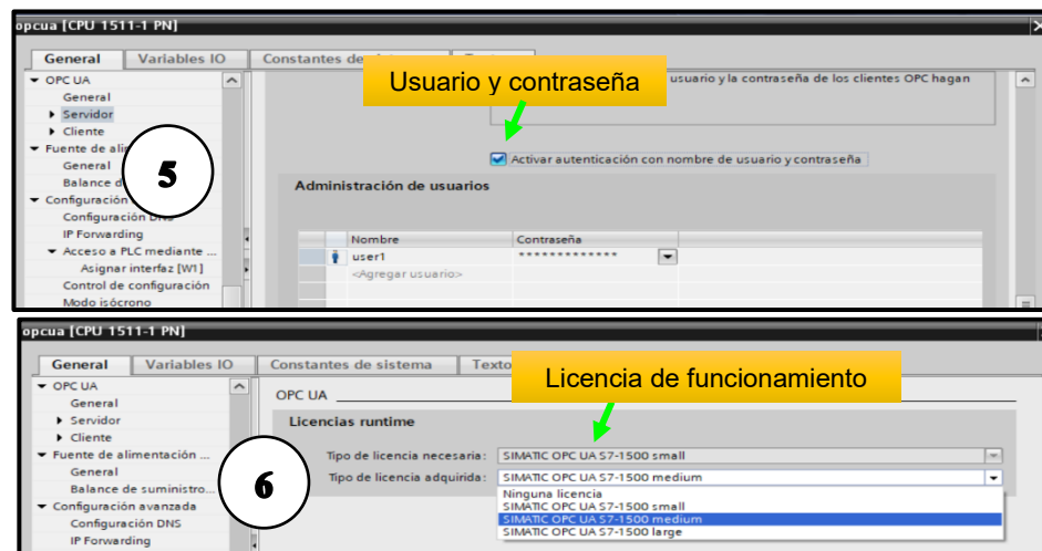
Ilustración 68, selección de usuario y contraseña y licencia de funcionamiento del servidor opc-ua, elaboración fuente propia.
