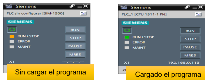
Ilustración 62, Estado de conexión del simulador, elaboración fuente propia.
