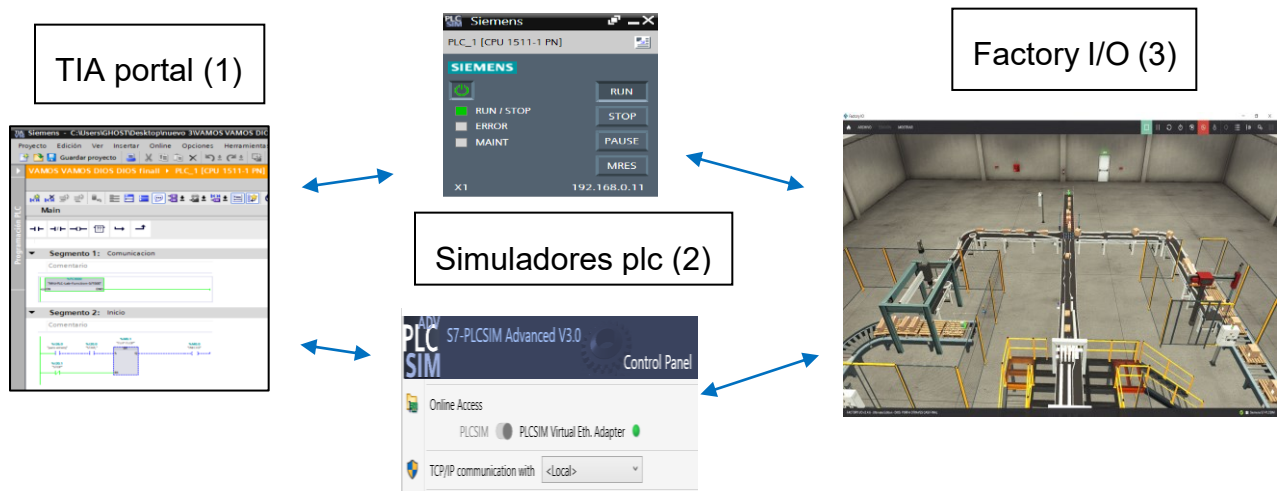
Ilustración 56, diagrama de las plataformas utilizada para simular del comportamiento del PLC, elaboración fuente propia.
