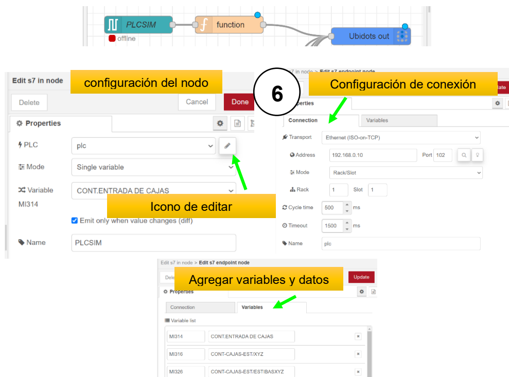
Ilustración 77, configuración del nodo PLCSIM, elaboración fuente propia.
