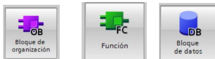
Ilustración 93, bloques de función del TIA portal, elaboración fuente propia.
