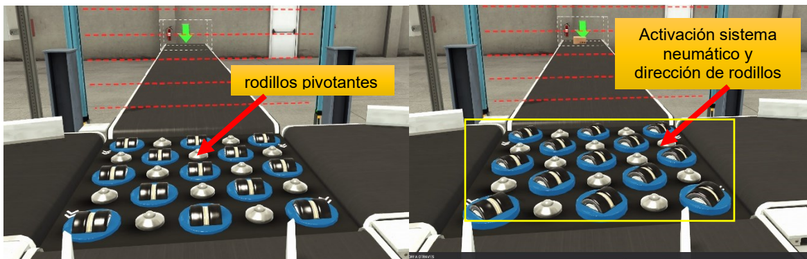
Ilustración 33, Funcionamiento clasificador de cajas, fuentes elaboración propia.
