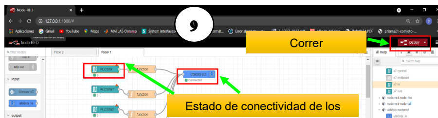
Ilustración 79, Estado de conectividad de los nodos, elaboración fuente propia.
