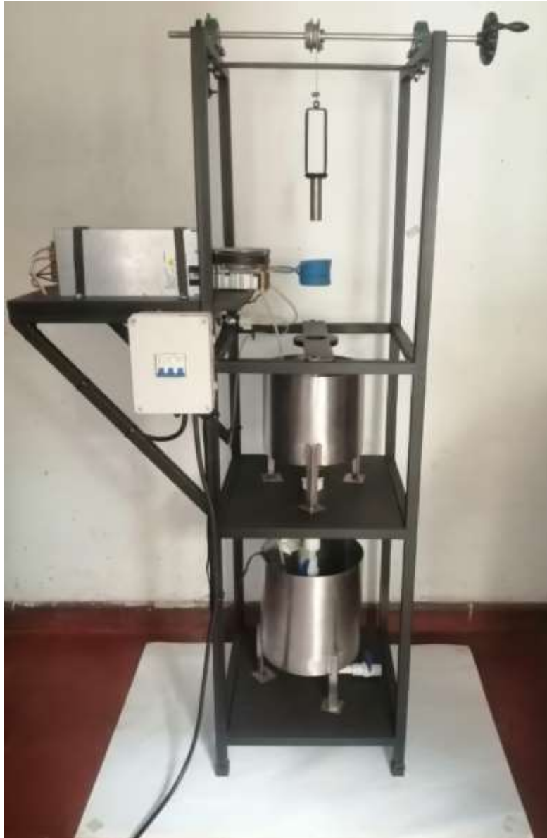
Figura 40: Maquina construida para el ensayo de Jominy. (Fuente propia)
