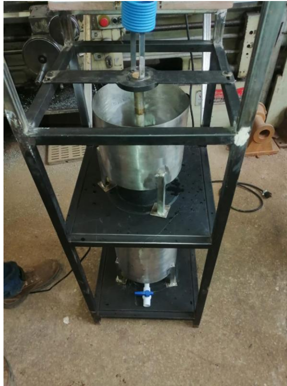
Sistema de recirculación construido
