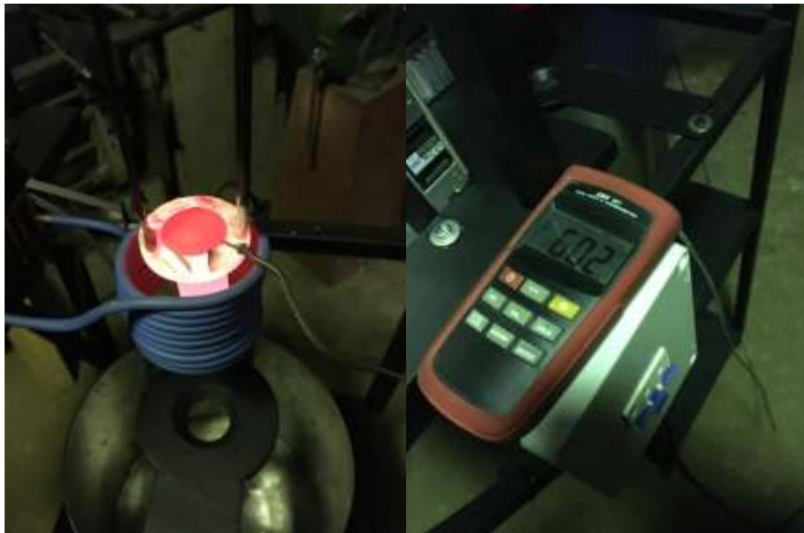
Figura 41: Medida de temperatura por termocupla tipo K de contacto. (Fuente propia)
