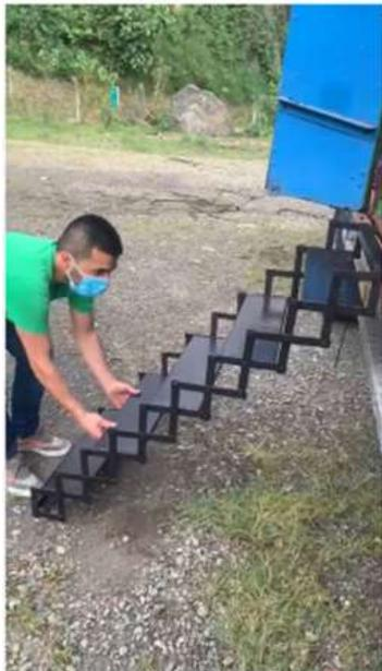
Despliegue del mecanismo desde el punto de anclaje a la superficie plana del suelo.
