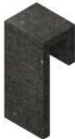
Esta pieza está construida en material ASTM A-36 ya que este es un material comercial en Colombia, lo que se busca es comprobar que tanto la forma como el material sean óptimos para el sistema de anclaje.
