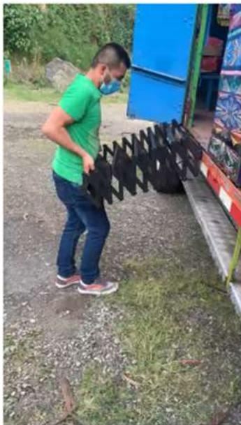
Pliegue del mecanismo escalera plegable y desinstalación del soporte de enganche del vehículo.
