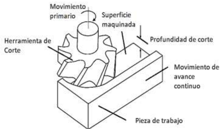
Figura 3. Proceso de Fresado Frontal. Modificada de [18]
