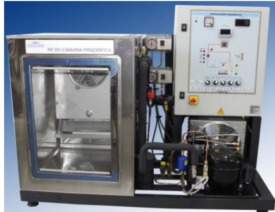
Figura 2-10: RF 01.1 -Cámara De Enfriamiento marca DIKOIN.
