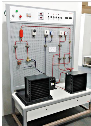
Figura 2-11: Banco de refrigeración – INSUR.
