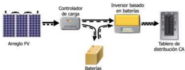
Figura 10. Diagrama de bloque de un sistema fotovoltaico.
