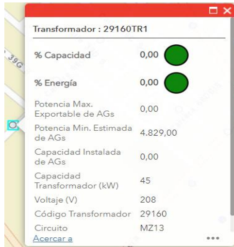
Ilustración 36: Evidencia de interconexión del transformador a sistemas fotovoltaicos. Fuente: Codensa.
