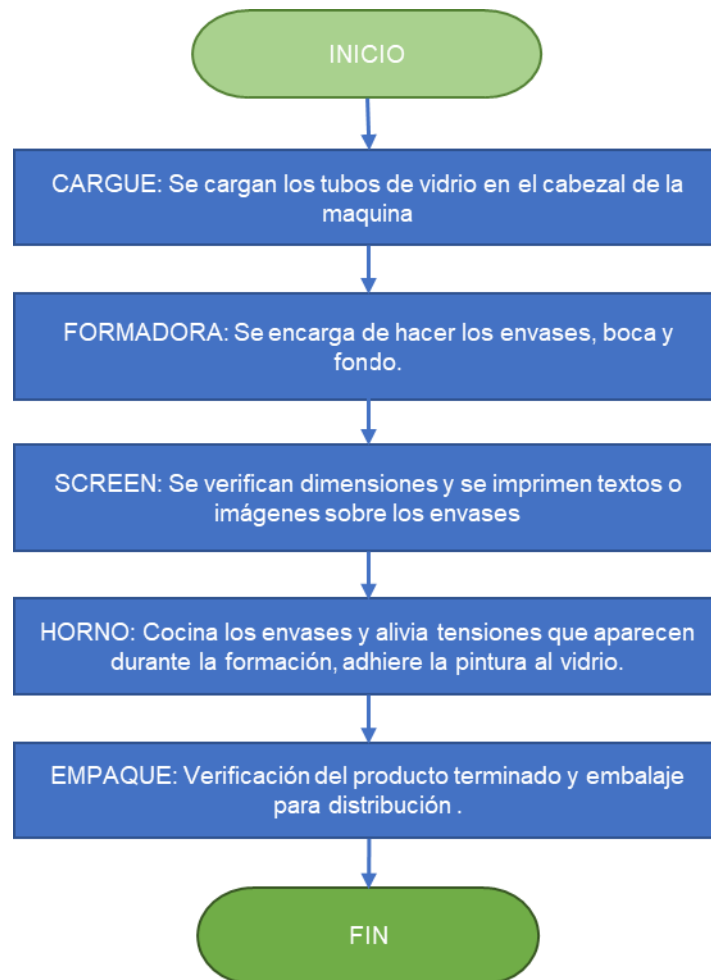
Figura 6. Proceso de fabricación envases de vidrio (viales-ampollas)
