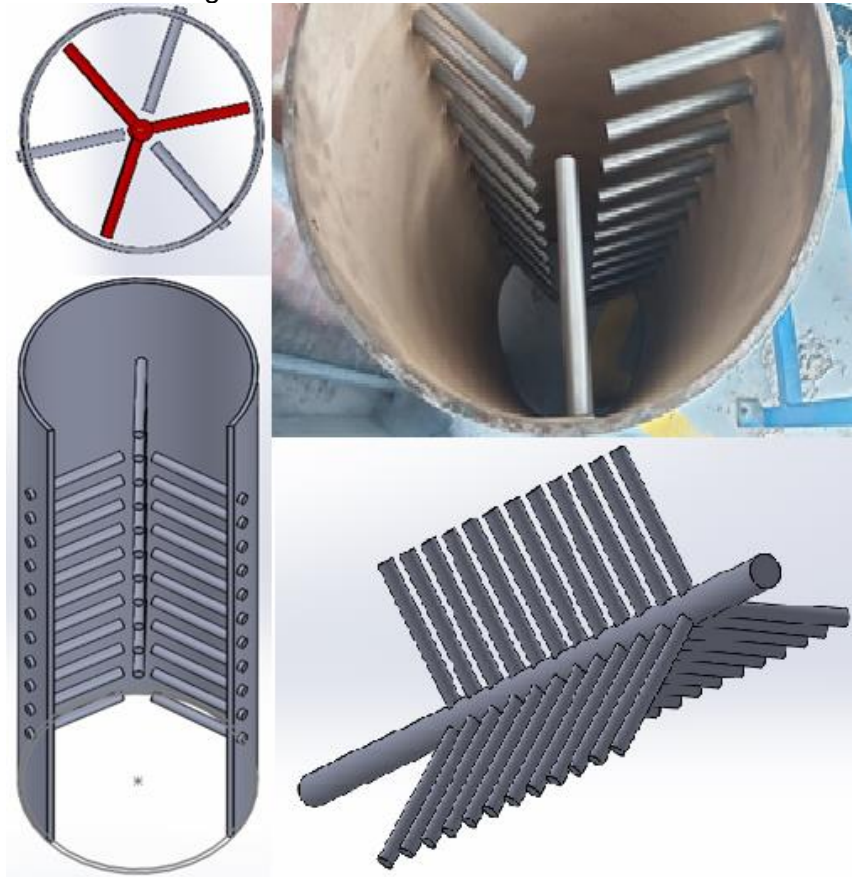
Figura 44. Cámara de trituración actual
