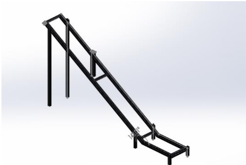
Figura 38. Estructura soporte de banda transportadora
