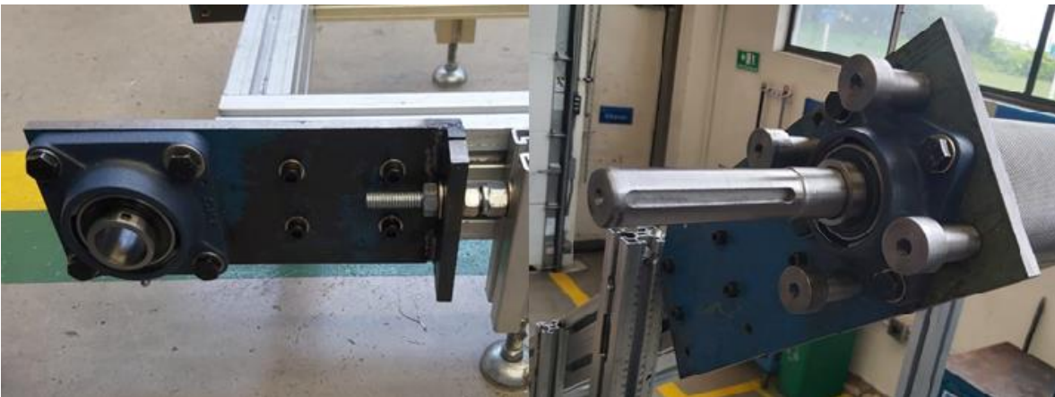
Figura 52. Platinas de fijación instaladas
