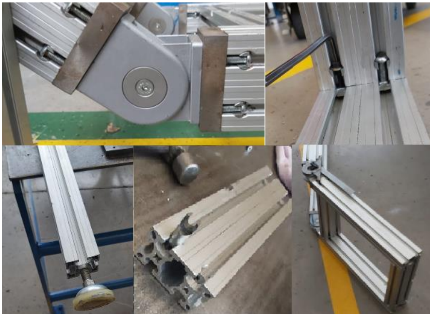
Figura 50. Proceso ensamble de estructura
