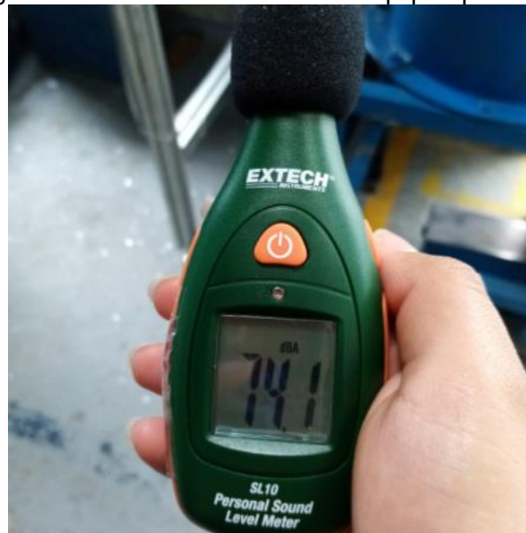
Figura 55. Medicion nivel de ruido equipo optimizado
