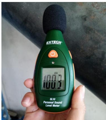
Figura 16. Medición del nivel de ruido
