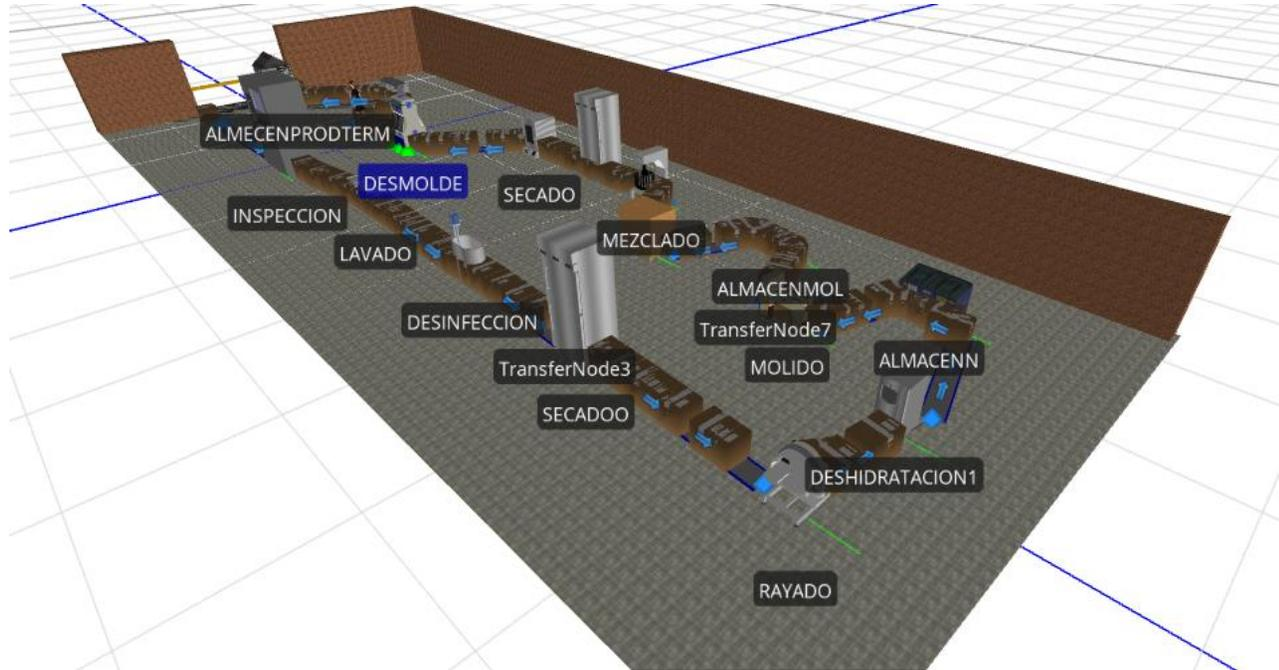
*Nota.* Flujo que lleva la fabricación de las vajillas donde se pueden observar los diferentes procesos que intervienen. Se observa la distribución de la maquinaria en la planta y se hace un proceso secuencial debido a la dependencia de actividades.
