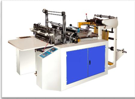
*Ilustración 6. Máquina de elaboración de bolsas. fuente Rujan Toyo (2021)*
