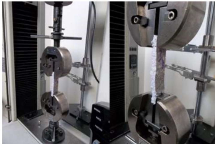
Figura 1. Fotografía de la izquierda, instalación de una probeta. Fotografía de la derecha, Falla a tensión de la probeta.
