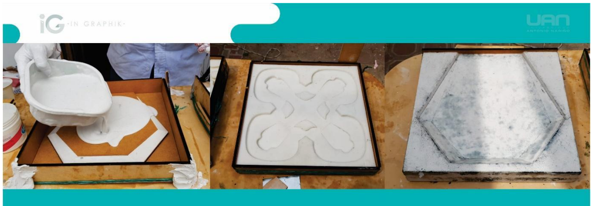
Imagen 15: Fotos del proceso de elaboración de moldes
