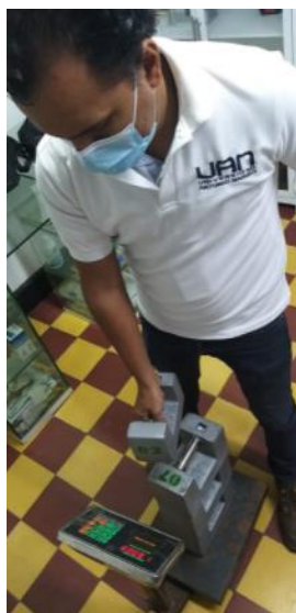
Figura 6 - Procedimiento experimental para 80 kg de masa nominal
