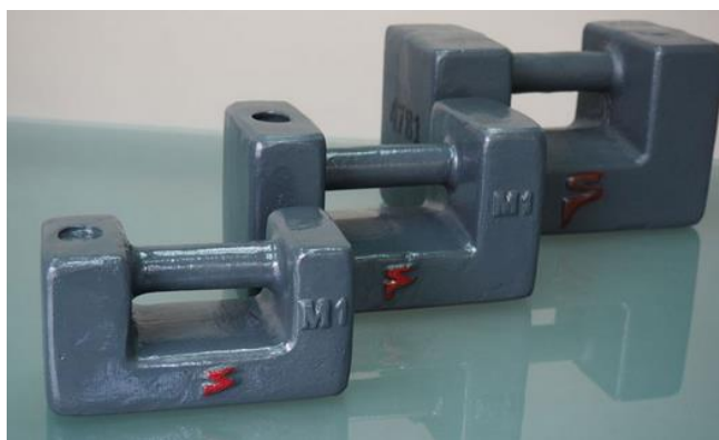
Figura 3 – Pesas patrón de medición utilizada en la calibración
