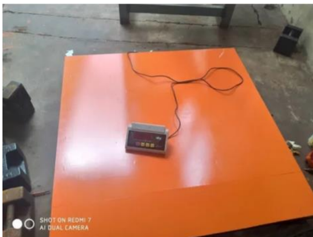
Figura 2 – Bascula de pesaje utilizado para su calibración
