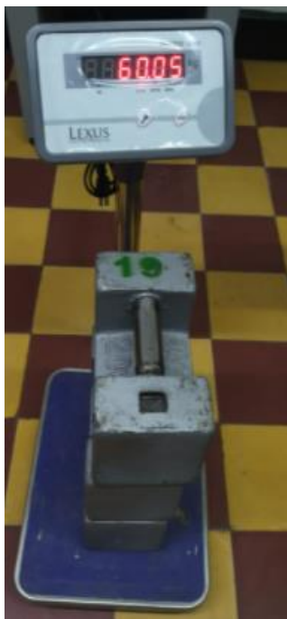
Figura 3 - Procedimiento experimental para 60 kg de masa nominal
