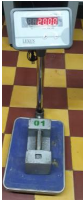
Figura 2 - Procedimiento experimental para 20 kg de masa nominal
