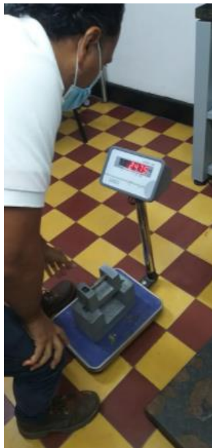
Figura 5 - Procedimiento experimental para 30 kg de masa nominal
