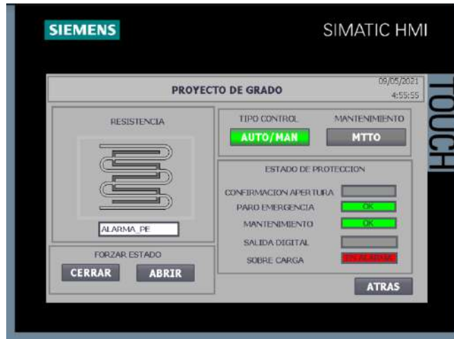
Figura 67 Alarma de sobre carga de la resistencia
