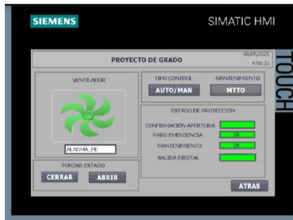
Figura 76 Alarma de correcto funcionamiento motor ventilador
