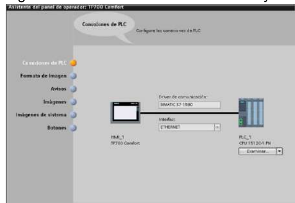
Figura 58 Enlace correcto entre la HMI y PLC
