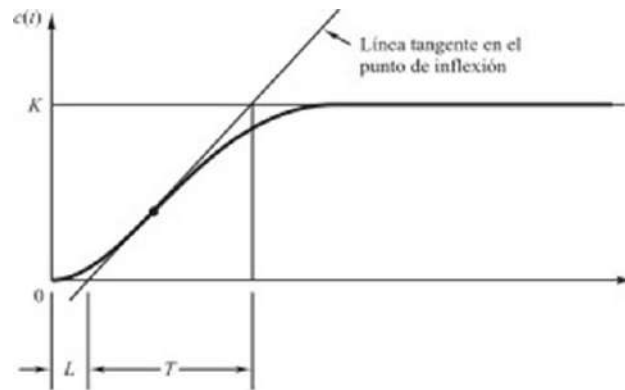
Figura 24 Respuesta a un escalón unitario de una planta.
