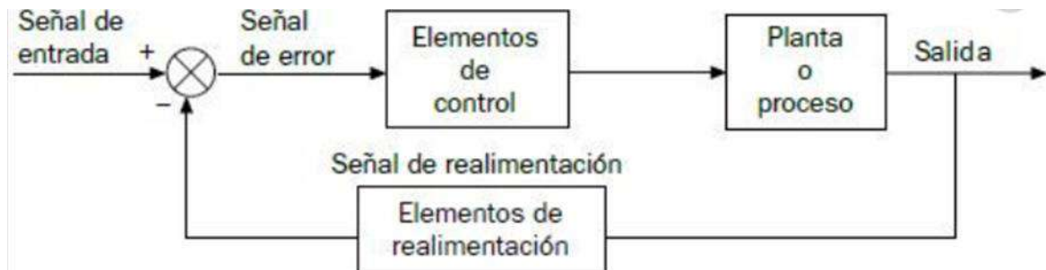
Figura 21 Sistema de control en lazo cerrado
