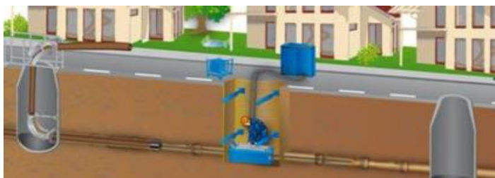
Figura 3 Rotura de tuberías. Fuente (Tracto, 2019)
