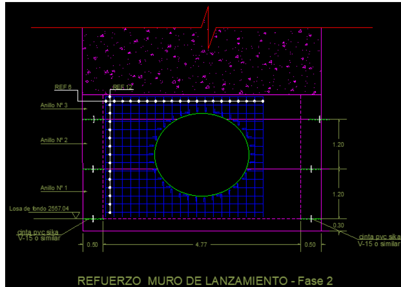
Figura 22 Muro de lanzamiento Pozo de lanzamiento. Fuente (I.H.T. S.A.S., 2020)
