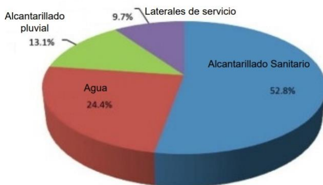
Figura 12 Proyectos ejecutados con rotura de tuberías. Fuente (Ariaratnam et al., 2014) Trad. del inglés
