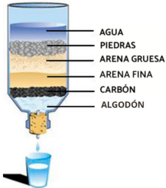
Figura 12. Filtro de carbón activado.
