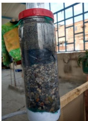
Figura 19. filtro de carbón activado.
