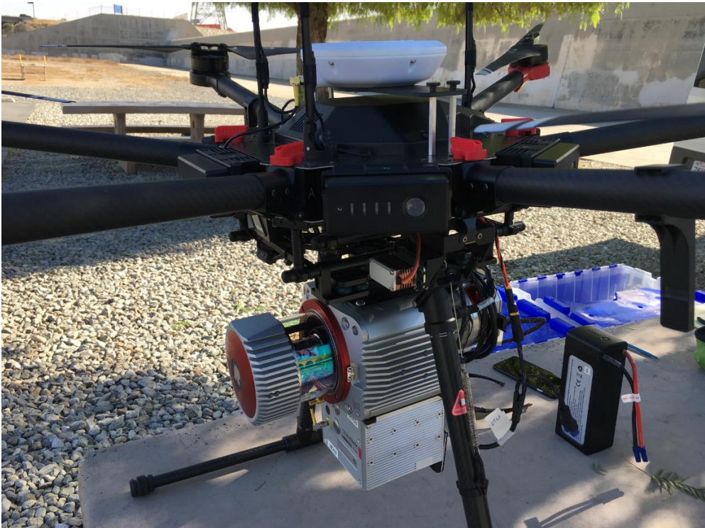
Figura 2. Sensor Riegl VUX-LR Tomada en el área de estudio, Equipo Ewatt AeroSpace vuelo de calibración
