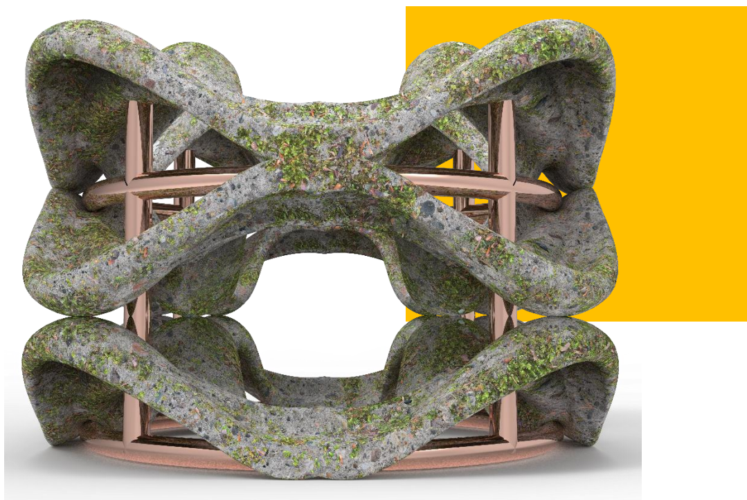
Figura 43, Estructura artificial arrecifal, conformada bajo escenario de funcionalidad térmica por la tubería de cobre. Elaboración propia (2021).
