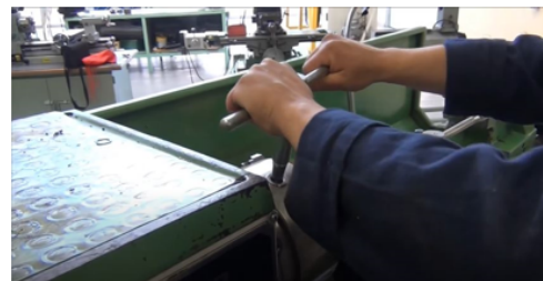
Sujetar llave copa soltar o apretar firmemente
