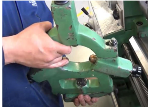
Levantamiento de elementos pesados: lunetas, copas, ejes.
