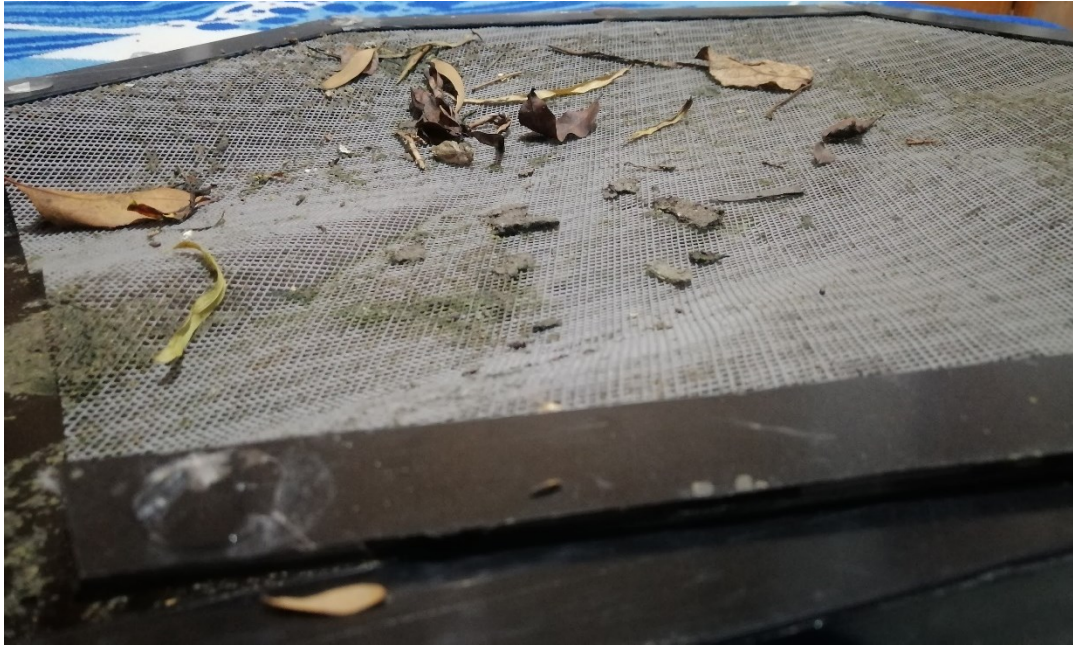
Ilustración 46 Material sedimentado en malla inferior. Elaboración: propia
