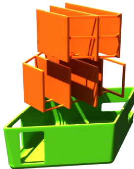
Ilustración 26 Unión paredes sedimentadoras. Elaboración: Propia
