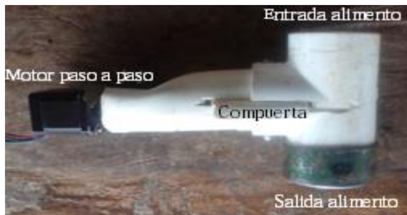
Figura 5-37 Vista lateral de la compuerta
