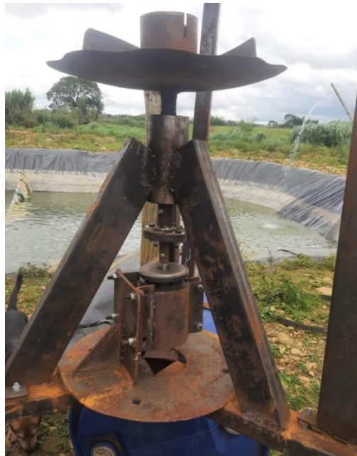
Figura 5-43 Montaje del disco horizontal en estructura
