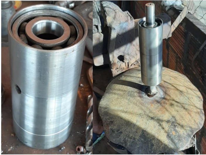
Figura 5-42 Cilindro con rodamientos 6306N y montaje
