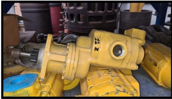
Fig. 19. Motor de arranque neumático. Desde la fig. 16., hasta la fig. 19., otorgada por colaboración de un trabajador de un complejo minero.
