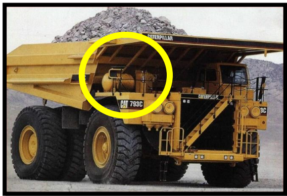
Fig. 14. Identificación de tanque de almacenamiento.
