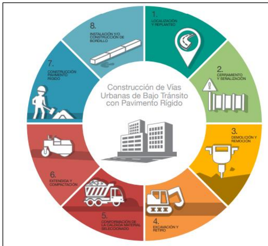
Figura 10. Proceso constructivo, construcción de vías urbanas de bajo tránsito con pavimento rígido
