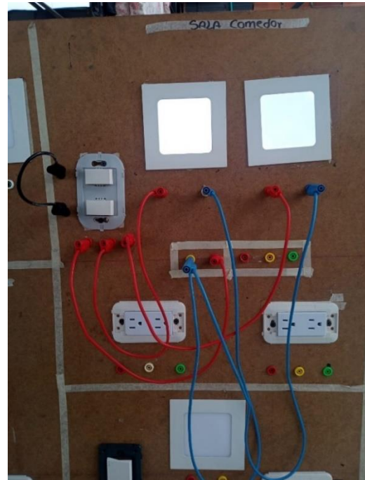
Figura 9 Montaje de prueba interruptor doble Fuente: elaboración propia
