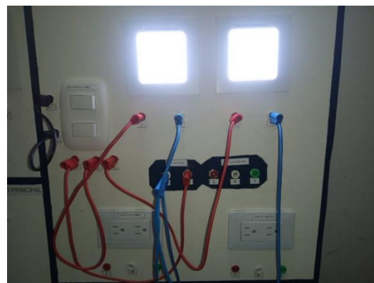
Figura 14 Montaje de prueba interruptor doble Fuente: elaboración propia
