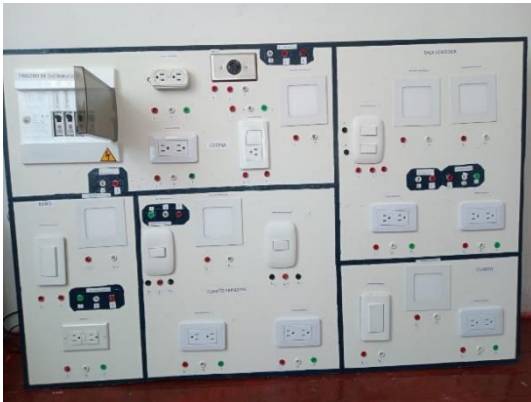
Figura 7 Banco de pruebas de cargas residenciales Fuente: elaboración propia
