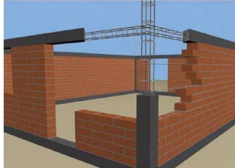
Image 39.: muros en ladrillo lizo de arcilla Fuente: mampostería, ingecivil.net,2018.
