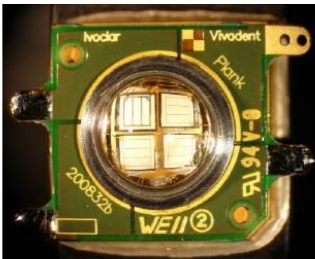
Fig. 4: Prototipo de un LED (diodo emisor de luz) que cubre la franja de longitud de onda de 380 hasta 515 nm.
