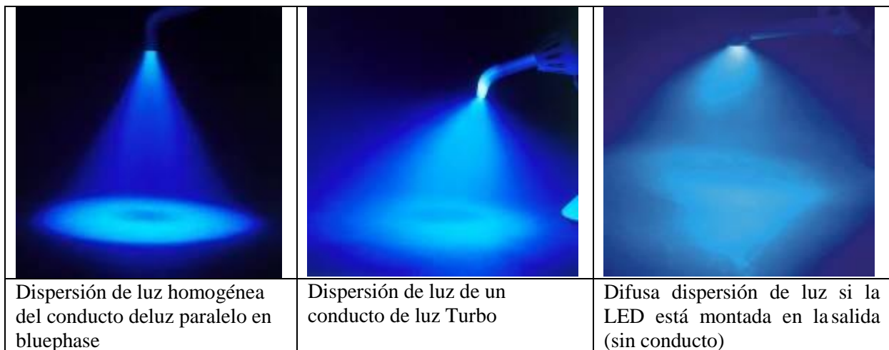
Fig. 7: Características de la dispersión de luz de diferentes conductos de luz
